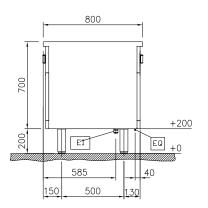
Electrical inlet (power) Equipotential screw
